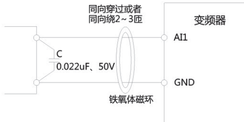
图3-17 模拟量输入端子处理接线图
